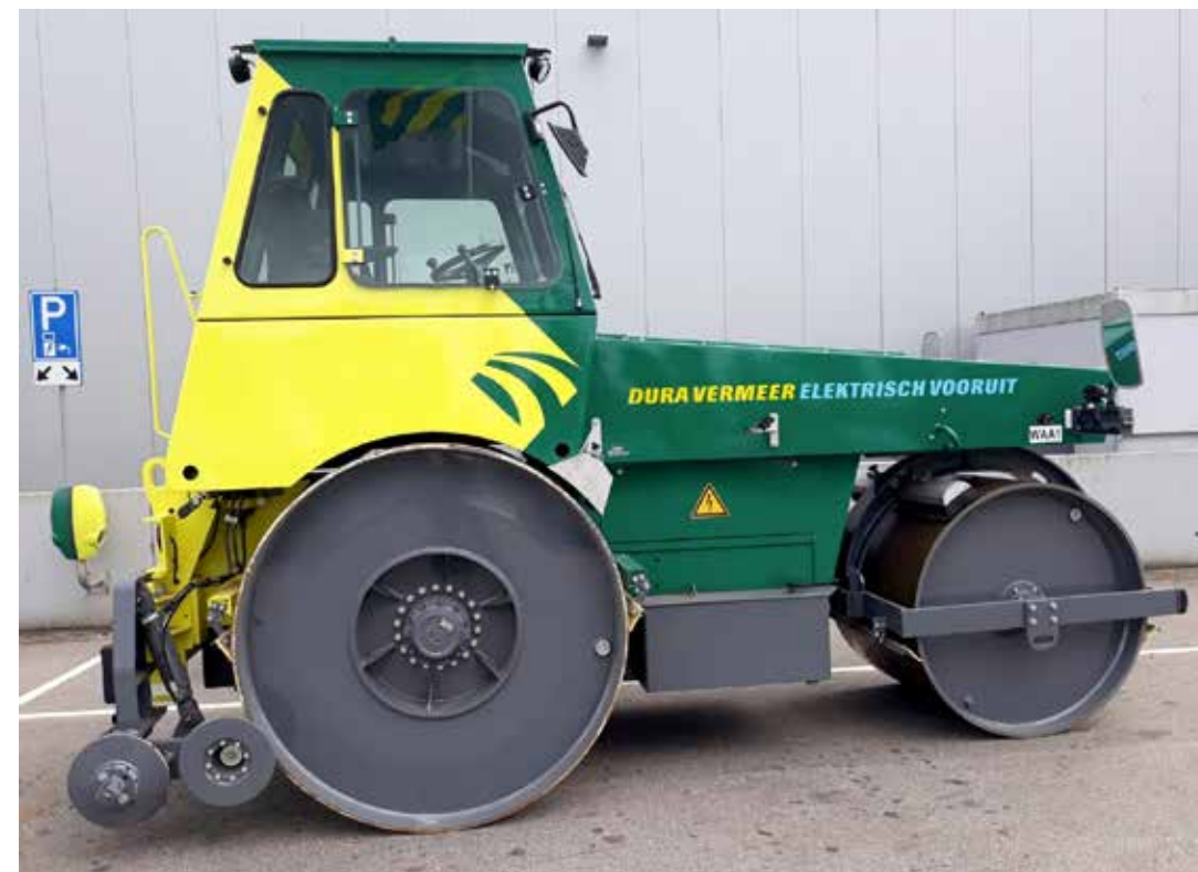
Volledig elektrische wals.
