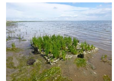
Proeftuin taludbescherming: GEO-wall stortsteen, houten taludbakken (van damwandplanken), BESE-elementen op Westfriese Vaart
