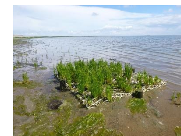
Proeftuin taludbescherming: GEO-wall stortsteen, houten taludbakken (van damwandplanken), BESE-elementen op Westfrieze Vaart 50 m
